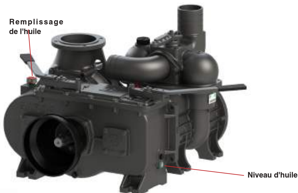
Figure 5 Remplissage huile/inspection (paramètres fiche plus haut)
