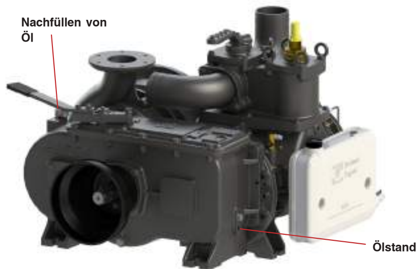
Abbildung 4 Nachfüllen von Öl/Inspektion (Parameter Tabelle oben)
