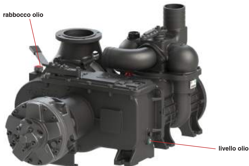
Figura 4 Rabbocco olio/ispezione (parametri scheda sopra)
