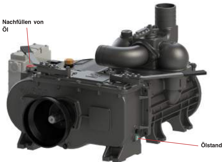
Abbildung 6 Nachfüllen von Öl/Inspektion (Parameter Tabelle oben)
