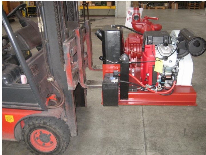
Abbildung 1: Anheben des motorisierten Aggregats
