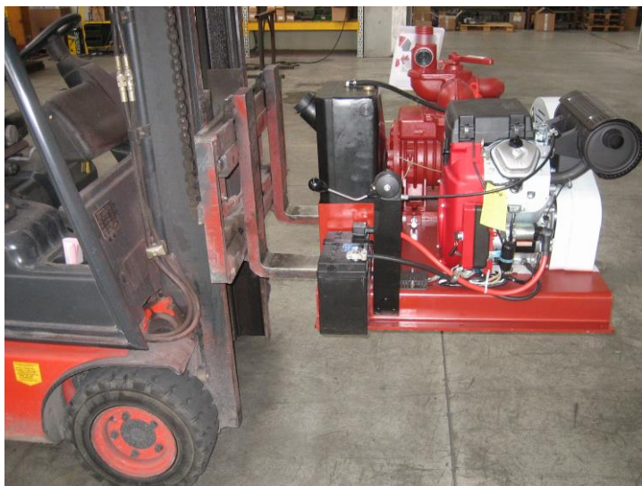
Figura 1: Levantamiento del grupo motorizado
