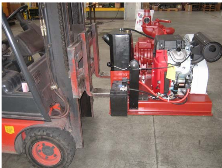
Figura 1: Sollevamento del gruppo motorizzato
